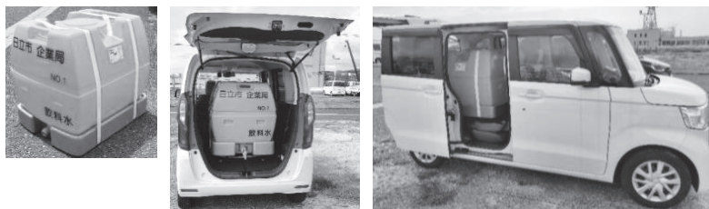
携行型給水に使用する給水タンク
